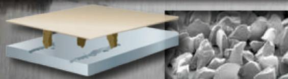
Обычное керамическое абразивное зерно имеет неправильную форму. Такое зерно «вспыхивает» обрабатываемый металл, перегревая его, что снижает скорость обработки и сокращает срок службы абразивного круга.
