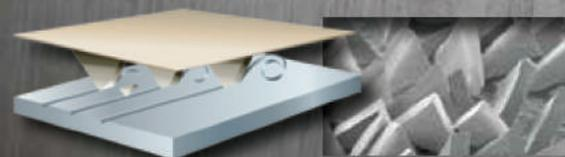
Благодаря зерну точной формы 3M™ зачистные круги 3M™ Cubitron™ II быстро и равномерно прорезают металл, оставляя отличный результат и не перегревая поверхность. Самозатачивание абразивных зерен в процессе шлифовки обеспечивает постоянную агрессивность резания и более длительный срок службы круга.
