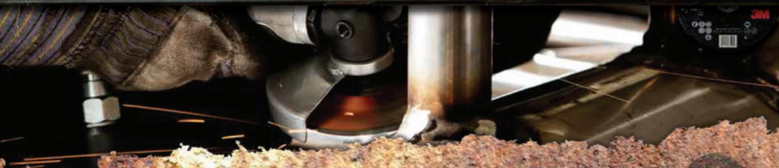
Зачистные круги 3M™ Cubitron™ II обеспечивают высокую скорость обработки различных типов металлов. Они используются как для удаления сварных швов, так и для многих других задач, требующих большого съема металла.
