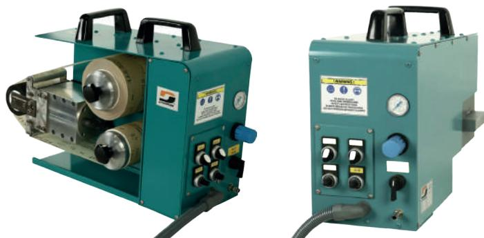
Dynabrade Superfinisher и микроабразивы обеспечивают предсказуемую, последовательную повторяемость выполнения операций по отделке рулонов. Они позволяют быстро удалить дорожки и линии геометрии (включая коронки) и последовательно получать шероховатость до 0,025 мкм Ra или более тонкая отделка на хромированной, прессованной бумаге, нейлонах, охлажденном железе, ротогравюре, эпоксидных и полиуретановых рулонах и других поверхностях.
