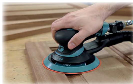
Спецификация : Мощность 224 Вт • 12 000 об/мин • Крепление оправки (шпindelь 5/16"-24) • Подключение воздушное 1/4" внутренняя резьба • Внутренний диаметр подводящего шланга 8 мм • Потребление воздуха 538 л/мин • Рабочее давление 6.2 бар • На все модели установлены комфортные платформы
