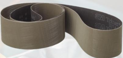
**307 EA Trizact™** Гибкие шлифленты из мягкой вискозной ткани предназначены только для работы всухую при легком или среднем усилии нажатия. Применяются для чистовой обработки изделий из нержавеющей стали, никелевых и кобальтовых сплавов, хрома, закаленной стали и цветных металлов. При обработке углеродистой и нержавеющей стали позволяют получить поверхность вплоть до 11-го класса без применения полировальных паст. Зернистость: A100, A65, A45, A30, A16, A6
