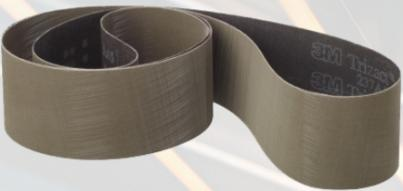
**253 FA Trizact™** Полуэластичные шлифовальные ленты на особо прочной основе из влагостойкого полиэфирного полотна специально разработаны для мокрого шлифования. Применяются для чистовой обработки изделий из нержавеющей стали, никелевых и кобальтовых сплавов, цветных металлов. Позволяют получить поверхность вплоть до 11-го класса без применения полировальных паст. Зернистость: A45, A30, A16, A6
