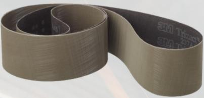
**237AA Trizact™** Полугибкие шлифовальные ленты предназначены только для работы всухую при небольшом нажатии. Применяются для чистовой обработки изделий из нержавеющей стали, никелевых и кобальтовых сплавов, хрома, закаленной стали и цветных металлов. При обработке углеродистой и нержавеющей стали позволяют получить поверхность вплоть до 11-го класса без применения полировальных паст
