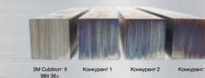
На фото изображены 4 идентичных бруска из нержавеющей стали после 9-ти циклов обработки по 10 секунд каждый. Три бруска, обработанные с помощью классической абразивной ленты, демонстрируют разные степени нагрева, в то время как брусок, обработанный Cubitron™ II, не имеет прижегов.\*
